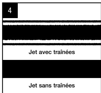
Déverrouillez le levier de la gâchette. Pointez le pistolet vers la surface à environ 30 cm (12 po) de celle-ci avant d'appuyer sur la gâchette. Si des traînées persistent même à haute pression, choisissez une buse plus petite ou diluez le produit.
