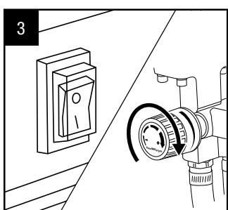
Tournez l'interrupteur d'alimentation sur MARCHE. Tournez le bouton de réglage de pression dans le sens des aiguilles d'une montre jusqu'à ce que la pompe démarre.
