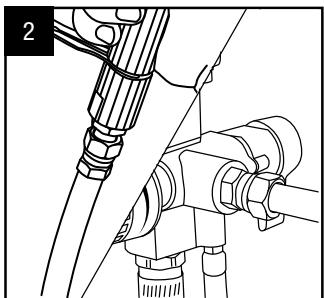
Raccordez le tuyau flexible au pistolet et au pulvérisateur.
