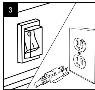
Apague el interruptor. Enchufe el rociador en el tomacorriente conectado a tierra.
