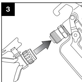
Insérez l'écrou en premier dans la protection du pulvérisateur, tel qu'illustré, la partie courbée de l'écrou étant alignée avec le trou de la buse. Utilisez le pointeur en plastique sur la buse pour mettre correctement l'écrou en place, si nécessaire.
