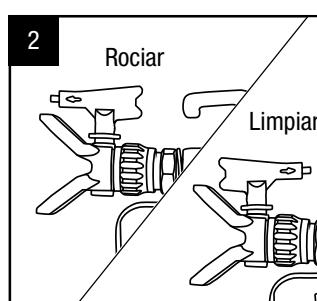
Instale la boquilla y el protector en la pistola y ajustela con la mano. Si la boquilla de la pulverizadora se obstruye, gírela para eliminar la obstrucción rápidamente sin necesidad de desarmarla. (Consulte la página 8 para conocer las instrucciones de ensamblaje)
