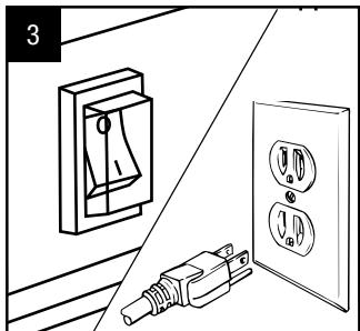
Tournez l'interrupteur d'alimentation sur ARRÊT. Branchez le pulvérisateur sur une prise électrique mise à la terre.
