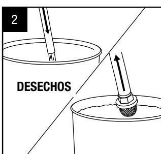
Coloque el tubo de retorno en un recipiente para desechos. Sumerja el tubo de succión en agua (materiales con base acuosa) o en una solución diluyente/limiadura (materiales con base oleosa).
