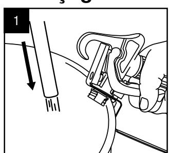
Plongez le tube d'aspiration dans la peinture. Tournez l'interrupteur sur MARCHE, dirigez le pistolet vers le seau de récupération et appuyez sur la gâchette. Si de la peinture s'échappe du tube de retour, tournez le bouton Prime/Spray sur SPRAY. Lorsque la peinture jaillit du pistolet, relâchez la gâchette. La pompe augmente la pression puis le moteur s'arrête.
