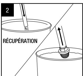
Placez le tube de retour dans un récipient de récupération. Plongez le tube d'aspiration dans de l'eau (pour les peintures à l'eau), du diluant ou du nettoyant (pour les peintures à l'huile).
