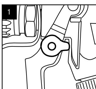
Coloque la palanca de seguridad del disparador en la posición de bloqueo. NOTA: Siempre trabe el disparador cuando no esté en uso, mientras realiza tareas de mantenimiento o durante el armado y la limpieza.
