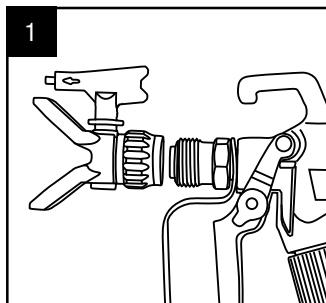
Quite la boquilla pulverizadora y el seguro de la pistola. Durante el primer uso de la pistola pulverizadora, la boquilla pulverizadora y el protector deben quitarse de la pistola.
