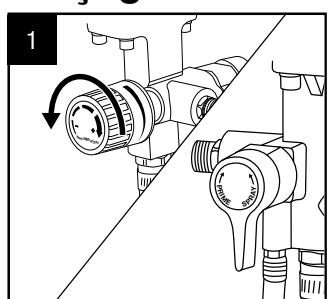
Tournez le bouton de réglage de pression dans le sens contraire des aiguilles d'une montre à la pression minimale. Tournez le robinet de d'amorçage / pulvérisation sur AMORCER (PRIME).
