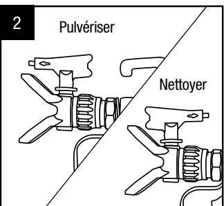
Installez la buse et le protecteur du pulvérisateur et serrez à la main. Si la buse est obstruée, renversez la buse pour supprimer le blocage sans désassembler le pulvérisateur. (Pour les instructions d'assemblage, consultez la page 8)
