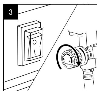
Encienda el interruptor. Gire la perilla de control de presión hacia la derecha hasta que arranque la bomba.
