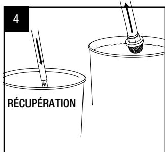
Laissez le liquide s'écouler du tube d'amorçage dans le seau de récupération pendant 30 à 60 secondes. Tournez l'interrupteur d'alimentation sur ARRÊT.
