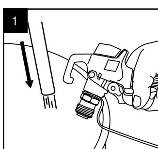
Sumerja el tubo de aspiración en la pintura. Encienda el interruptor y accione el gatillo de la pistola en dirección hacia el bidón de desechos. Cuando sale pintura por el tubo de retorno, gire la válvula de cebado/pulverización a la posición SPRAY (pulverizar). Cuando la pintura salga de la pistola, suelte el gatillo. Se acumulará presión en la bomba y se detendrá el motor.
