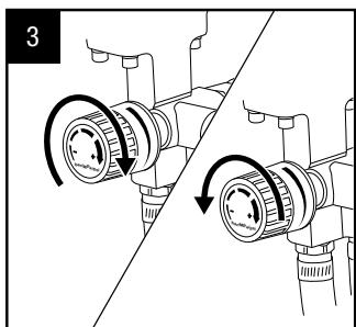
Tournez le bouton de réglage de pression du pistolet dans le sens des aiguilles d'une montre pour augmenter la pression et dans le sens opposé pour la réduire.
